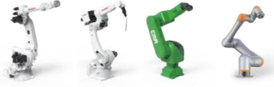
【通用工业机器人】 【焊接机器人】 【喷涂机器人】 【协作机器人】
